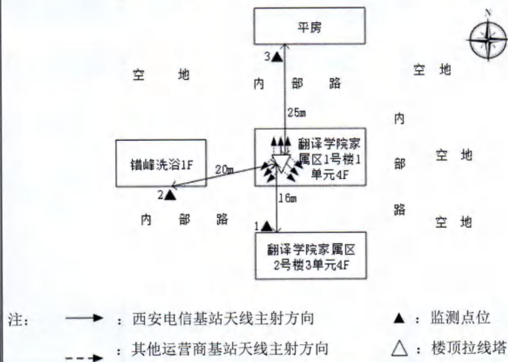
基站电磁辐射环境检测点位示意图
