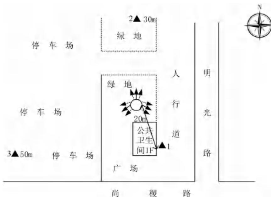
注： —▶：西安电信基站天线主射方向      ▲：监测点位
