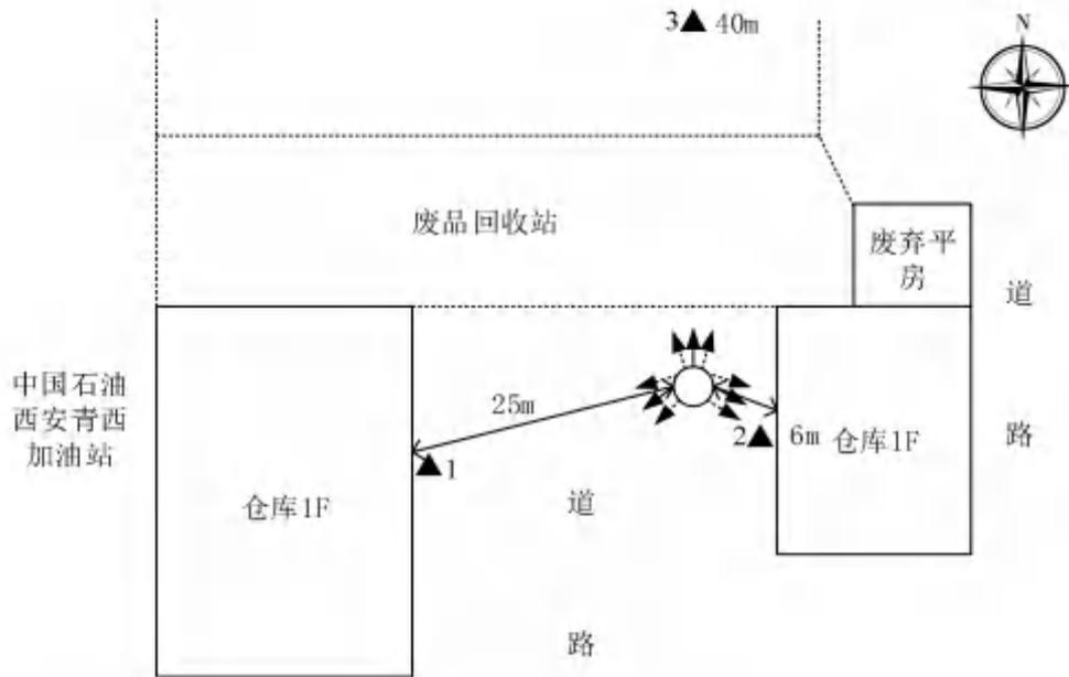
注： ———▶：西安电信基站天线主射方向      ▲：监测点位
