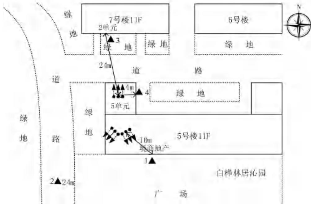
注： ———▶：西安电信基站天线主射方向      ▲：监测点位
