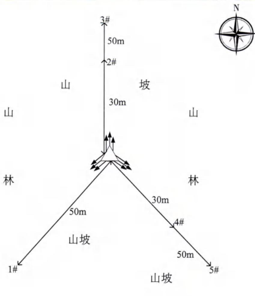
注： → : 基站天线主射方向      1#~5#：监测点位      △：落地拉线桅杆
